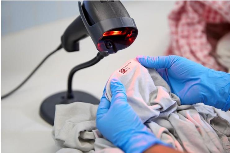
Abbildung 4: Beim digitalen Textilidentifikationssystem der Wäscherei werden die Textilien vor der Wäsche mittels QR-Code eingelesen.
