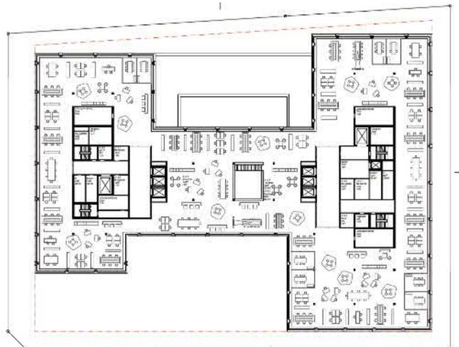
Abb. 19: Grundriss sechstes Geschoss, Richtprojekt in asymmetrischer H-Form (Stand 04.07.2017)
