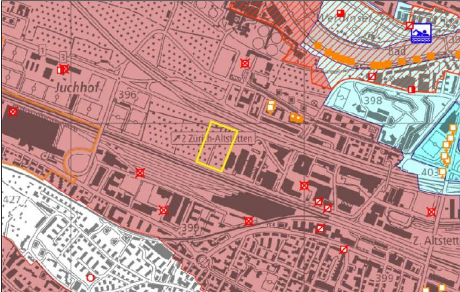
Abbildung 5-16 Auszug aus der Grundwasserschutz-Karte, rot: Gewässerschutzbereich A<sub>u</sub>, gelb: Projektperimeter (Quelle: <http://maps.zh.ch> am 10.02.2017)
