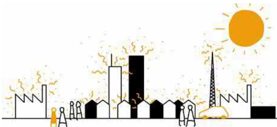
Abb. 64: Städtischer Wärmeenergiehaushalt für eine sommerliche Situation: Etwa 95 Prozent der Energie werden durch die Sonnenstrahlung zugeführt. Hinzu kommen 5 Prozent, die durch das Handeln des Menschen bedingt sind.
