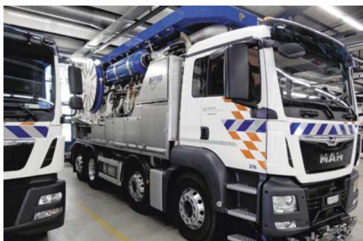
Das neue Fahrzeug der Entwässerung verfügt über eine fünf-stufige Filteranlage, mit der das abgesaugte Abwasser vor Ort gereinigt und in die Kanalisation zurückgegeben wird. (Bild: ERZ)
