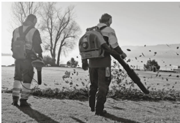
Elektro-Laubgebläse (links) im Vergleich zu einem mit Viertaktmotor. (Bild GSZ)
