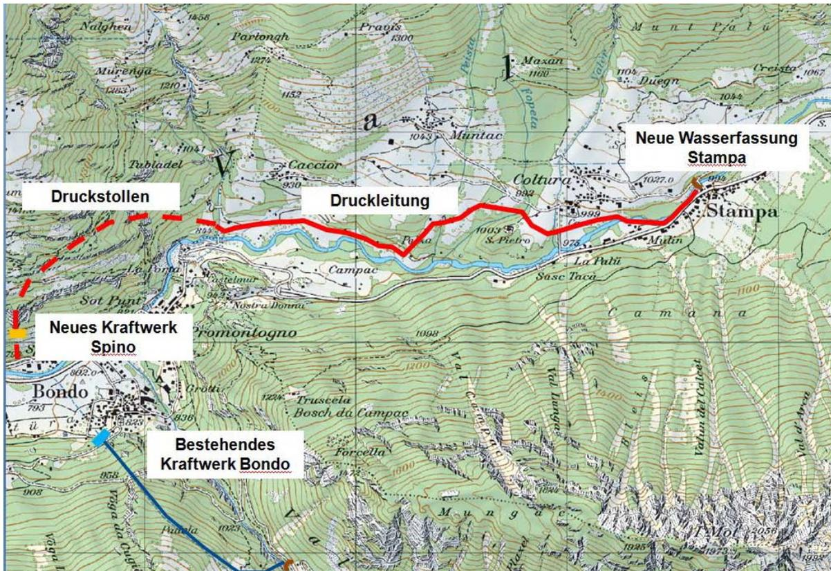
Abb. 2: Obere Stufe des Kraftwerkprojekts Bonda
